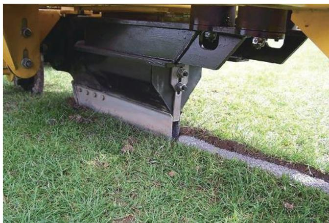
独自の注入口形状と高速振動で確実に砂を充填します。スリット掘削と砂の充填が一連の作業で素早く完了します。コースの透水性向上に効率的な作業を実現します。
