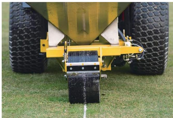
ブレードに追従する転圧ローラーによって充填後の不陸を防ぎ、プレーコンディションへの影響を最小限に抑えます。
