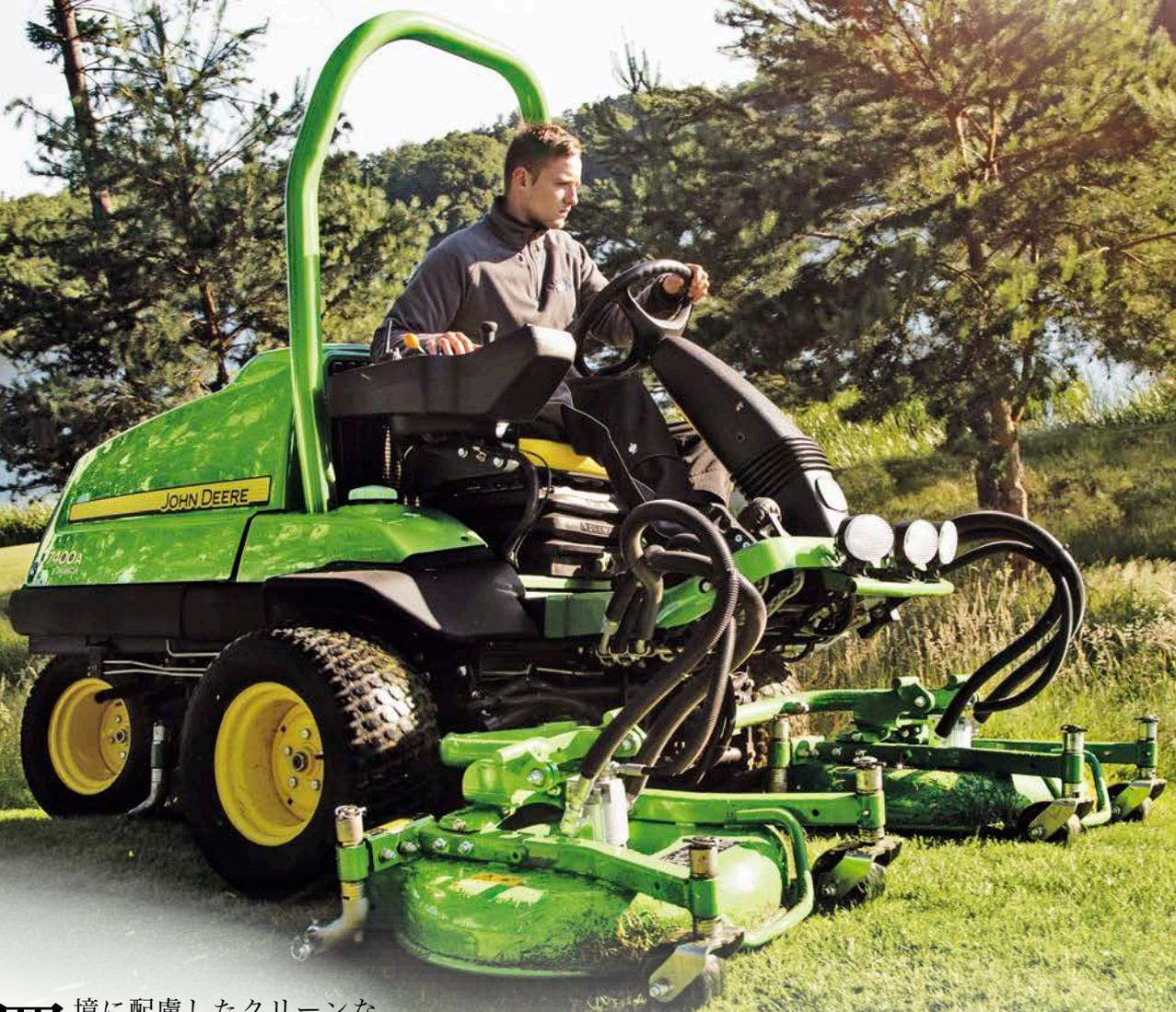
**環**境に配慮したクリーンな排気を実現しながら強力な馬力とパフォーマンスで高い評価を得ている7400A テレインカットトリム & サラウンドモアは登坂能力と燃料給油回数の軽減を実現しました。さらに最新の機能を備えた見やすい大型画面のテックコントロールディスプレイにはパスコード保護の機能があり、オペレーターによる刈高や仕上がりのムラを防ぎます。
