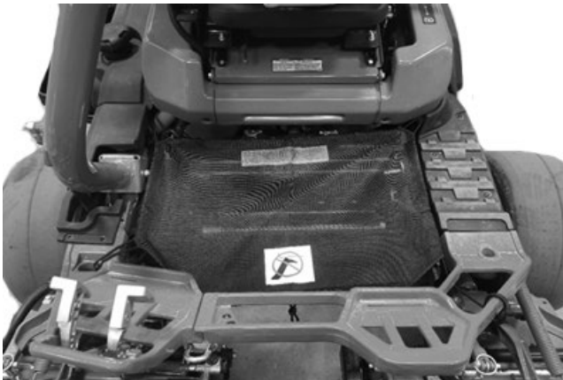
TCT100787-UN: 取り付けられたカバー
