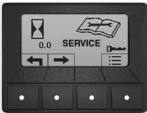
APY15555-UN: サービスメニュー画面 もう一度押すとメインメニューに戻ります。
