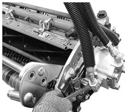
TCT100813-UN: モーターの取り外し
