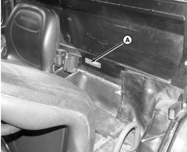
ラベルは運転席のシートベルトの裏側のキャブに取り付けられています APY30313—UN—12MAR20
