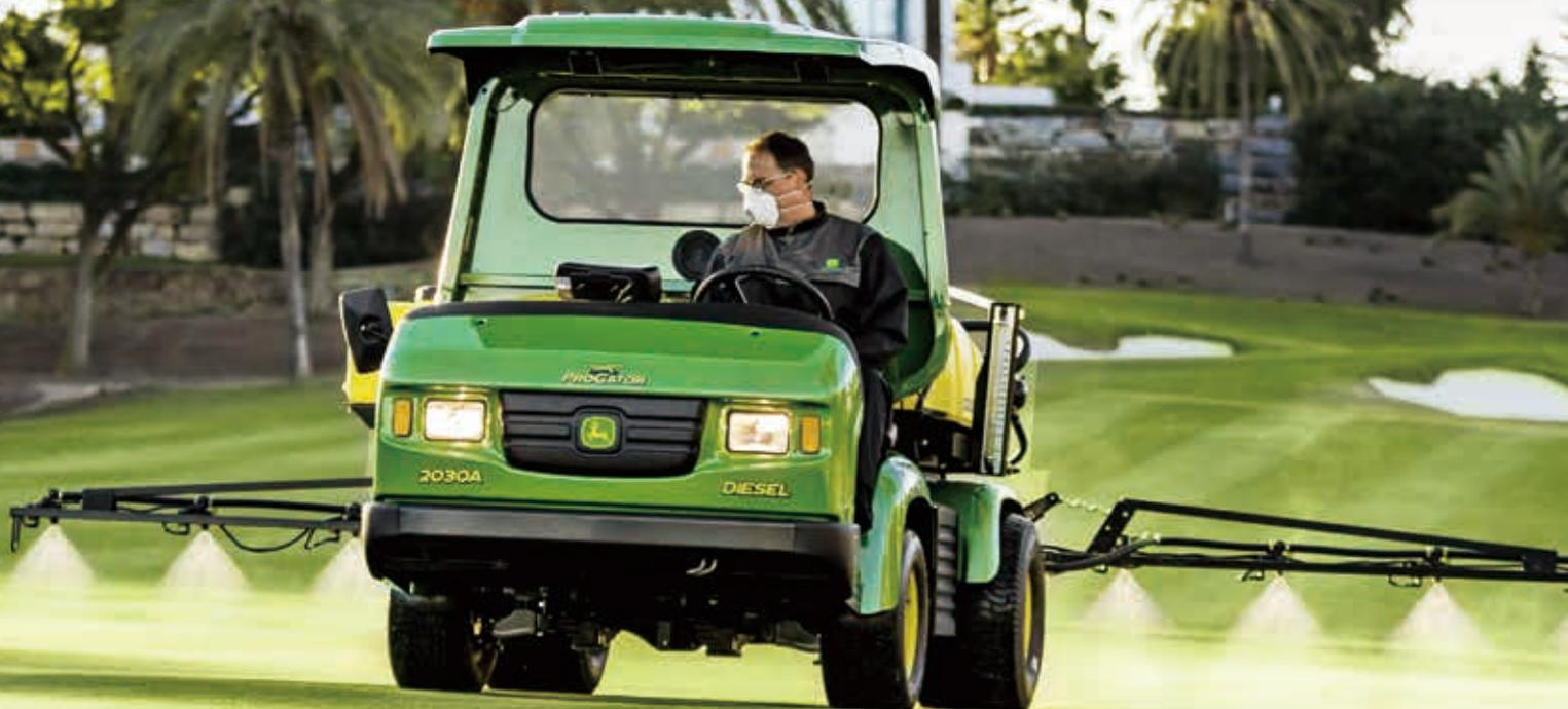
**独** 自開発の遠心ポンプを採用したジョンディアスプレーヤーシリーズは、自動レートコントローラーとのコンビネーションで幅広い水量レンジに対応し、正確な散布作業を可能にします。
